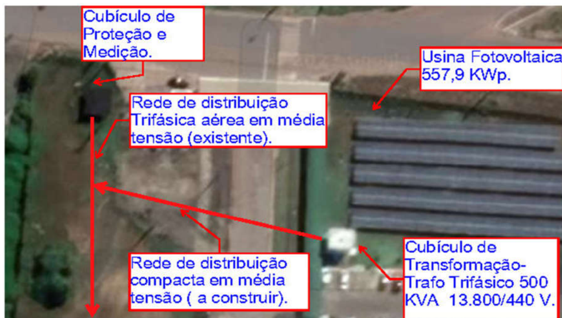
Imagem03- Lateral do sistema de energia do IFAP Campus Macapá.
